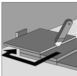
После приклеивания нанесите не менее 3-х слоев полиуретанового лака. Используйте рекомендованные двухкомпонентные эластичные лаки на водной основе (STRATO, LOBA). Нанесение лака производите точно в соответствии с инструкцией на упаковке лака. Соблюдайте время высыхания между слоями а также время окончательного отверждения лака также строго в соответствии с инструкцией по нанесению лака.
